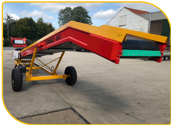
Optie: Haaks draibare hoofdwielen icm. Elektrische aangedreven hoofd wiel
