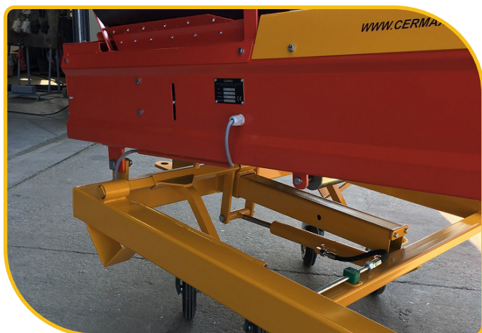
Eigenschappen: Hydraulisch verstelbare instorthoogte, Inschuifbare trekdisel
