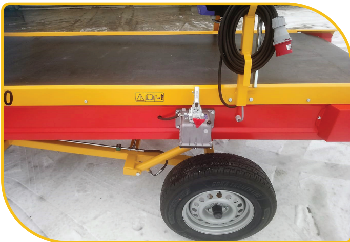
Eigenschap: hydraulische hoogte verstelling uitstortzijde
