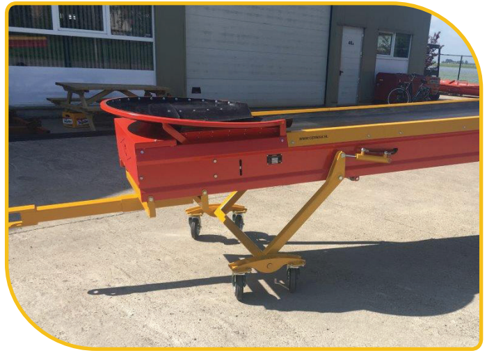
Optie: Hydraulische hoogteverstelling instort
